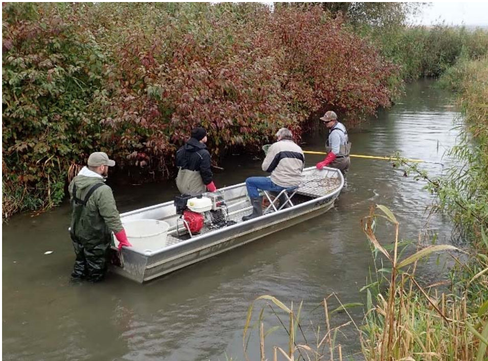
Abbildung 2: WRRL-Elektrobefischung per Boot (Bild: FaFi 2021)
