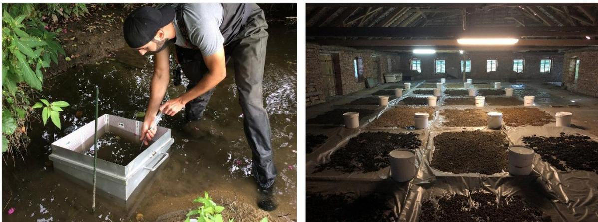
Abb. 5 Mittels eines Stahlrahmens wurde die Entnahmefläche der Sedimentprobe begrenzt (links). Die Sedimentproben mussten zur Siebung über mehrere Wochen getrocknet werden (rechts).
